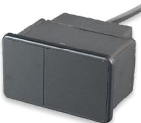
TOF/Start detektiert Personen oder Objekte, die sich Drehflügeltüren nähern. Dank seiner Richtungserkennungsfunktion stellt TOF/Start sicher, dass sich die Tür nur dann öffnet, wenn die Person auf diese zugeht. Läuft die Person an der Tür vorbei, wird sie ignoriert und ausgeblendet. Dies erhöht die Energieeffizienz.
