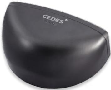
Die RDS-Radarsensoren bieten eine sehr zuverlässige Türaktivierung. Sie können dank ihres grossen Erfassungsbereich von 4 m × 2 m bei einer Montagehöhe von 2.2 m für alle automatischen Türen eingesetzt werden.
