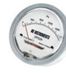
Differenzdruck-Zeigermanometer und Schräghrohrmanometer
