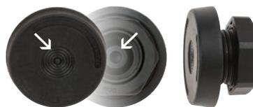
Die runden Kabeleinführungen DES PDMU sind eine platz- und zeit-sparende Alternative zu Standard-Kabelverschraubungen. Eingesetzt in die runden Bohrungen an Gehäusen, Schaltschränken und Maschinen werden sie mit der Gegenmutter fixiert und bieten so gute Zugentlastung und einen hohen IP-Schutz.
