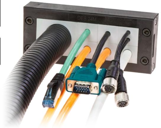
Die Modulrahmen DES 24M ermöglichen dank der verschiedenen verfügbaren Kabeltüllen die Einführung von vorkonfektionierten und nicht vorkonfektionierten Kabeln mit Außendurchmesser von 2 bis 34 mm. Der Rahmen wird mit zwei seitlichen Schrauben, beide auf der rechten Seite, geschlossen. Die kleinen und großen Tüllen können frei im Rahmen montiert werden.
