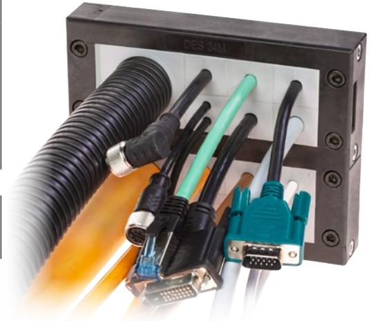
Die Modulrahmen DES 24 MX ermöglichen dank der verschiedenen verfügbaren Kabeltüllen die Einführung von vorkonfektionierten und nicht vorkonfektionierten Kabeln mit Außendurchmesser von 2 bis 34 mm. Das modulare System und die für DES-Rahmen typische Gleitschiene ermöglichen die Verwendung von kleinen oder großen Kabeltüllen, frei in Position und Anzahl. Für zukünftige Erweiterungen des Rahmens können Blind- oder perforierbaren Tüllen vorgesehen werden.
