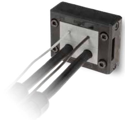
Das DES Q Kabeleinführungssystem besteht aus einem teilbaren Rahmen, kleinen (SPP), mehrfach (X) oder großen (SPG) Kabeltüllen, welche im gleichen Rahmen Platz finden. Zukünftige Änderungen der Kabelgrößen können dadurch problemlos durchgeführt werden. Dank der robusten und hochwertigen Konstruktion ist das DES Q System ein sehr langlebiges Produkt.
