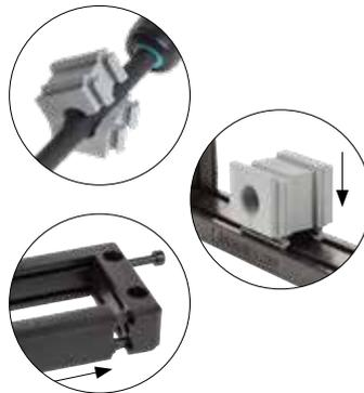
Das DES 16 Kabeleinführungssystem besteht aus einem teilbaren Rahmen, kleinen (SPP), mehrfach (X) oder großen (SPG) Kabeltüllen, welche im gleichen Rahmen Platz finden. Zukünftige Änderungen der Kabelgrößen können dadurch problemlos durchgeführt werden. Dank der robusten und hochwertigen Konstruktion ist das DES 16 System ein sehr langlebiges Produkt.
