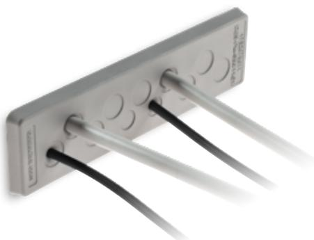
Die DES-PM S ist eine innovative Alternative zu Standard-Kabelverschraubungen an elektrischen oder elektronischen Geräten und Schaltschränken. Das Kabel wird einfach durch die vordere Membrane gestochen, während die zweite Membrane für die Zugentlastung und den Flüssigkeitsschutz sorgt.
