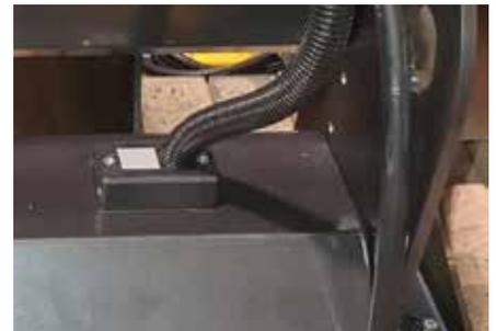
Die teilbaren Rahmen DES L2 und L3 ermöglichen das Einführen vorkonfekzionierter Kabel, von 2 – 16mm Durchmesser, durch die Gehäusewand. Gleichzeitig bieten sie eine starke Zugentlastung und einen guten Wasserschutz.
