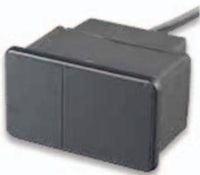
TOFniva ist ein vielseitiger Sensor zur Überwachung von Flächen. Der Überwachungsbereich kann so eingestellt werden, dass er den Anwendungsanforderungen entspricht. So kann der Sensor für die Überwachung von Notausgängen eingesetzt werden. Sobald sich ein Gegenstand in diesem Bereich befindet, schaltet TOFniva einen Ausgang und kann z.B. einen Alarm auslösen.
