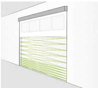
Absicherung Sektional- und Schnellauftore
