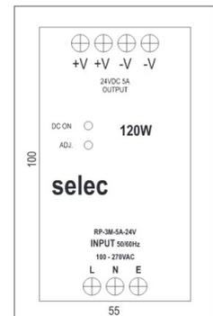
**Schaltnetzgeräte für die DIN-Schienen Montage**
