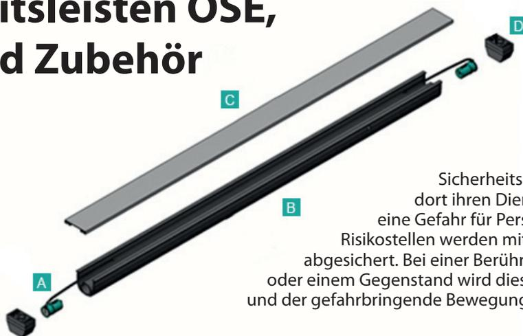
Sicherheitsleisten verrichten überall dort ihren Dienst, wo bewegte Kanten eine Gefahr für Personen darstellen. Die Risikostellen werden mit Gummihohlprofilen abgesichert. Bei einer Berührung durch eine Person oder einem Gegenstand wird dieses Schaltprofil verformt und der gefahrbringende Bewegungsvorgang gestoppt.
